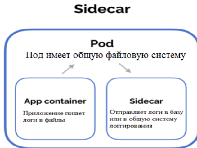
Рисунок 42 – Схема работы контейнеров в sidecar паттерне
